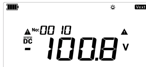
图9.3.3.4 直流负电压测量显示
