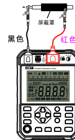
图10.1.1 常规两线测量接线示意图
