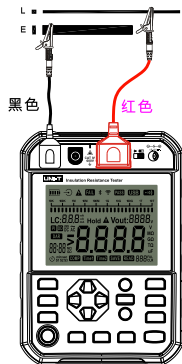
图9.3.2.1 电压测量接线示意图
